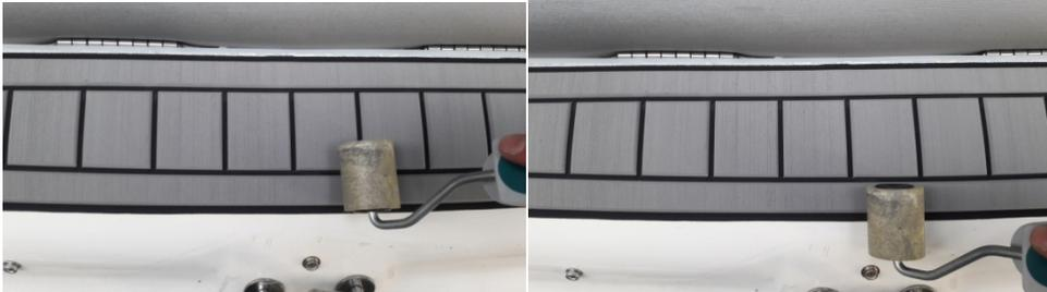
7. Wenn das Pad liegt, nun mit hohem Druck nochmals fest andrücken und die Luft nach außen drücken. Fahren Sie anschließend mit dem Roller umlaufend die Randkontur ab, um auch die Luft im Randbereich entweichen zu lassen. Im letzten Schritt drücken Sie die Außenkontur umlaufend fest an den Untergrund an.
