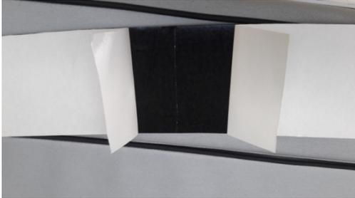
3. Legen Sie die Trägerfolie am Schnitt zu beiden Seiten ca.5cm um, so dass die Klebefläche in der Mitte zu sehen ist.
