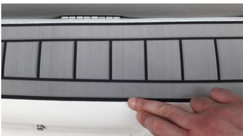
8. Überprüfen Sie die sichere Haftung der Pads und drücken Sie ggf. die Stellen nach. Entfernen Sie mögliche Reste des Primers bitte erst nach 2 Stunden nach der Verlegung mit einem leicht getränkten Lappen mit dem Reiniger.
